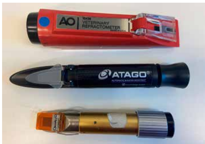
Olika typer av refraktometrar för analys av urinspecifik vikt.
