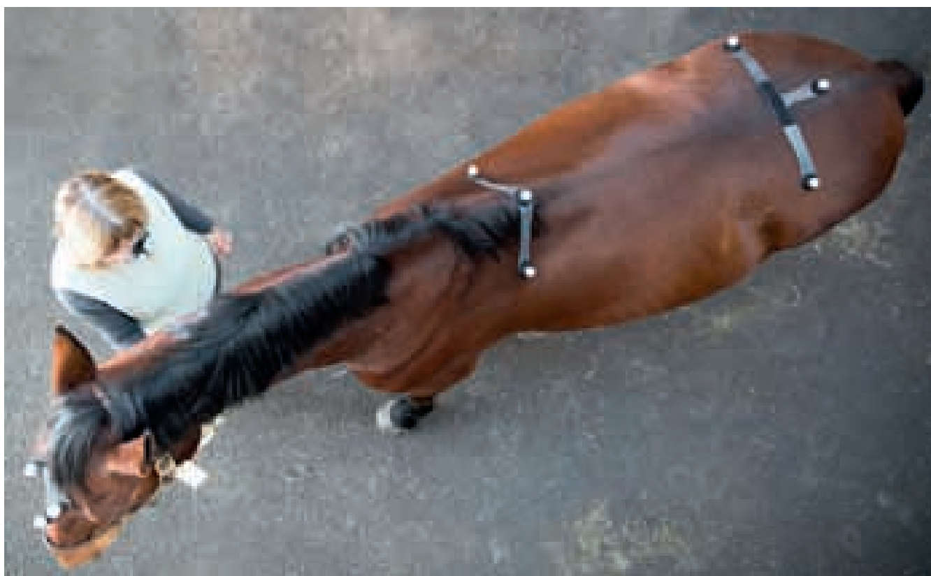
FIGUR 2. Häst försedd med markörer på huvud, manke och bäcken. Bild från företaget Qualisys.
