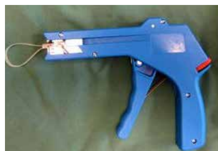
Exempel på ett verktyg som kan användas för att dra åt implantatets loop med ett förutbestämt moment.
