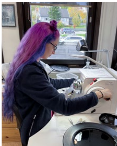
Leg BMA Sofie Hellgren jobbar vid rotationsmikrotomen och gör snitt av det paraffinbäddade provmaterialet.
